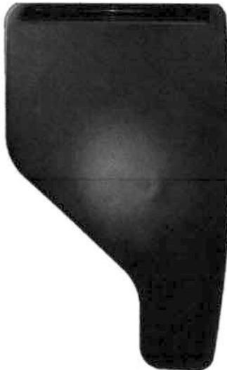
Prancheta lateral em polipropileno fundido com alta pressão, dotada com 2 (dois) porta lápis, ambos posicionados na face anterior ou posterior da prancheta medindo de largura 30 mm e comprimento 270 mm e parte menor com largura de 30 mm e comprimento de 200 mm, Espessura mínima de 05 mm, fixada à estrutura através de 04 (quatro) parafusos de cabeça chata.
